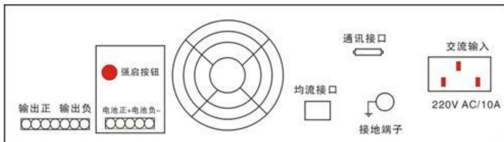
图 3-9 SOC-P4820/1000 电源箱背面板示意图
