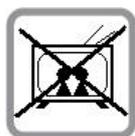
应使本设备远离加热装置和产生噪音的电器设备，例如日光灯、电动机和电视机。这些噪声源会干扰本设备的性能。
